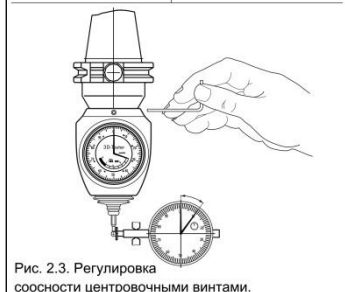
Рис. 2.3. Регулировка соосности центровочными винтами.
